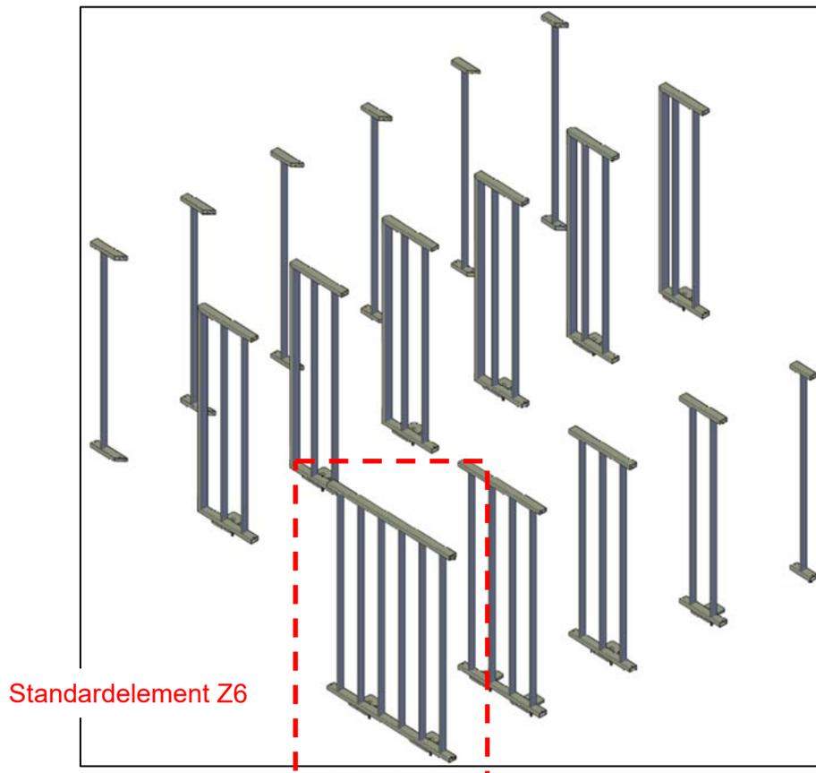
Ober- und Untergurt bestehen bei dem Staketen-Geländer aus einem Rechteckstahlrohr 40x20x2, die Staketen aus Flachstahl 30x6 und die Fußplatten aus 10mm Blech. Die Höhe des Geländers beträgt ca. 1.0m und der lichte Abstand zwischen den Staketen 118mm.
